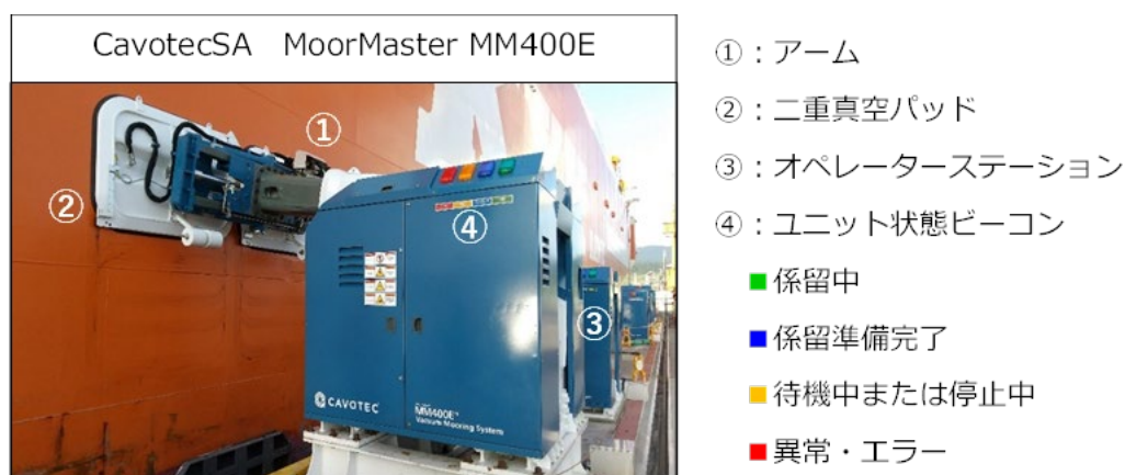
写真 1 自動係留装置による船舶の吸着状況
